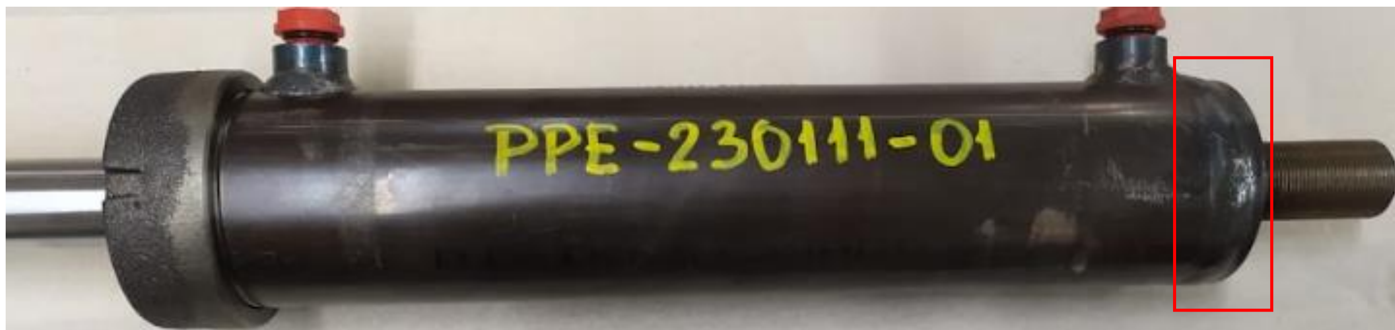
Figura 1: Fotografía recepción del cilindro hidráulico fallado. En recuadro rojo, se señala la zona donde ocurrió la fuga en la unión soldada tubo-tapa.
